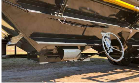
Conos de Descarga con sistema de guillotinas accionadas con volante lateral.
