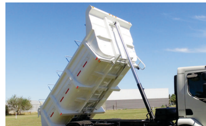
Cilindro hidráulico de 3 etapas.
