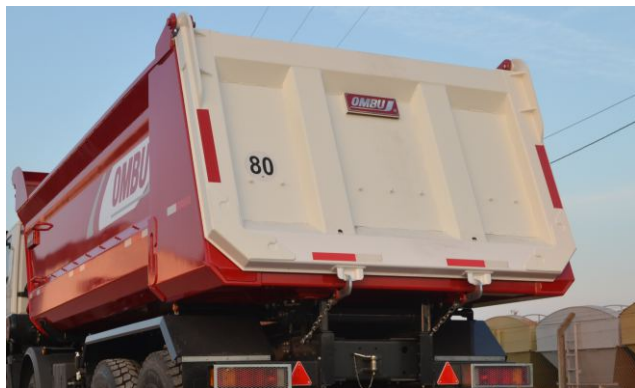
Puerta trasera de apertura simple y cierre automático.
