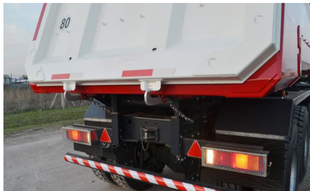
Puerta trasera de apertura simple y cierre automático.
