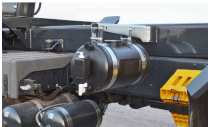
Tanque de agua
