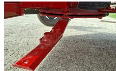
Sistema de cuchillas móviles con 4 filos.
