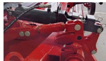
Sistema de traba para poder sacar el cilindro y registro de nivelación para inclinar la máquina.
