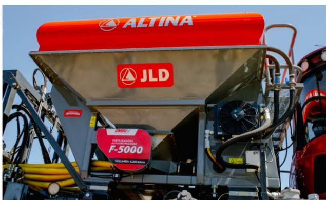
Tolva de acero inoxidable. Presurizada con removedor y criba anti-torrón. Con divisor de caudal de sólidos para mejor distribución del material dentro de la tolva. Evita derrames fuera de la misma.
