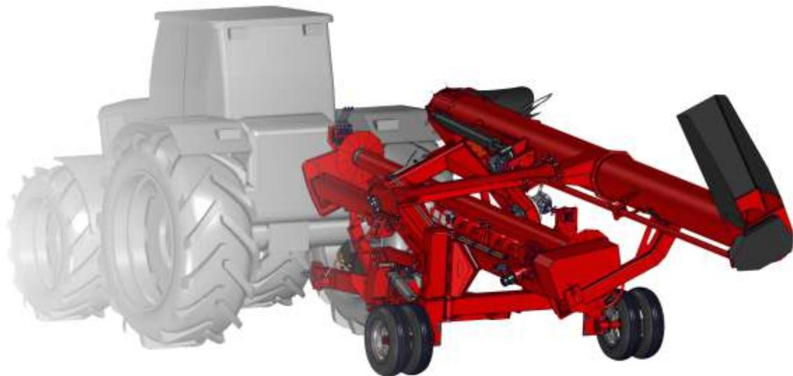
LA EXTRACTORA OMBU EHO POSEE UN SISTEMA AUTOTRAILER ESTE SISTEMA PERMITE QUE EL EQUIPO SE PUEDA MANIPULAR DESDE LA CABINA DEL TRACTOR. PARA ELLO, UNA VEZ LLEGADO AL LOTE DE TRABAJO Y DESTRABANDO LOS ELEMENTOS DE SEGURIDAD, SE PUEDE GIRAR EL PORTAROLO DE EXTRACCIÓN Y UNA VEZ UBICADO EN POSICIÓN COMENZAR CON EL TRABAJO DE RECOLECCIÓN DE GRANOS.
