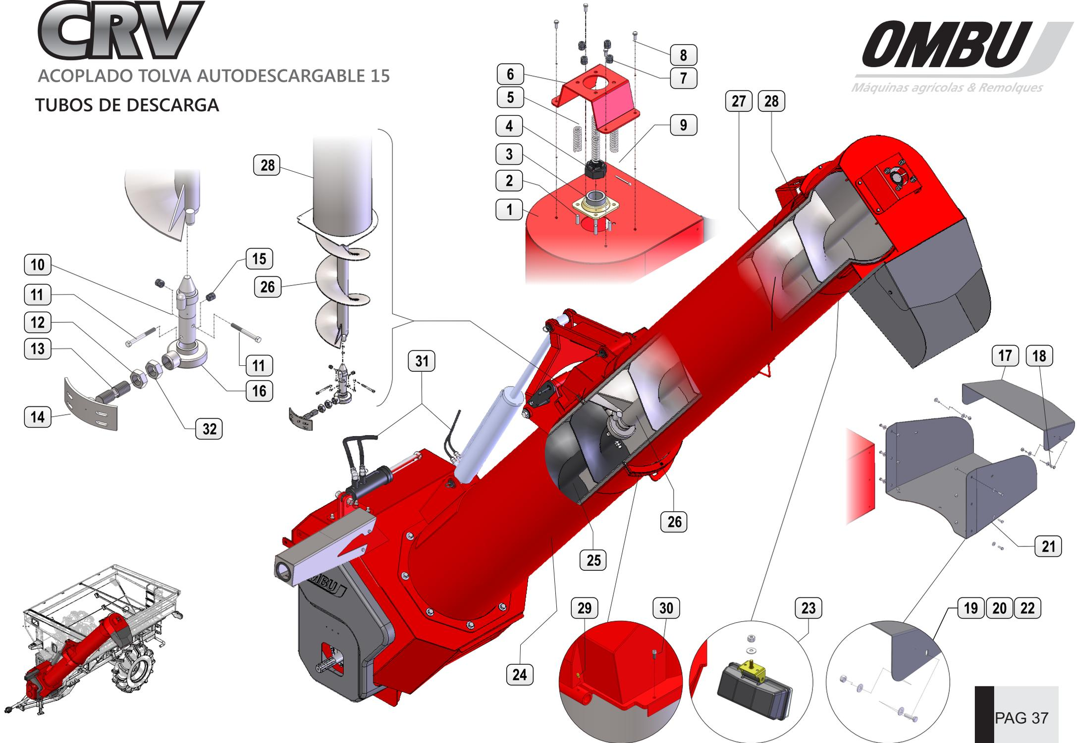
**TUBO DE DESCARGA - Detalle Tramo Inferior**
