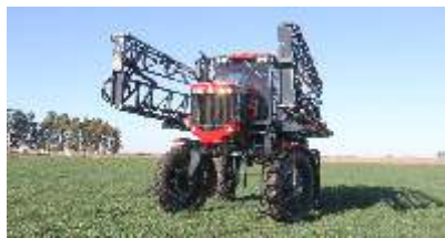
Posición de transporte con trabas laterales que evitan aperturas accidentales.
