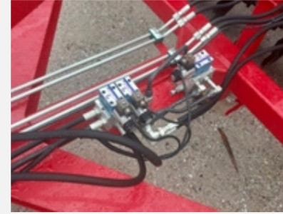
Electroválvula que divide los comandos entre regulación de altura de lanza e inclinación de la rastra hacia adelante y coloca el sistema de alas en flotación para asegurar el copiado de terreno y la correcta nivelación del mismo.
