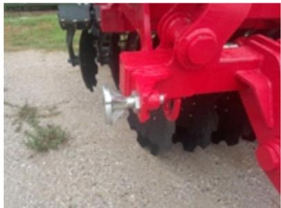
Sistema de nivelación de alas a rosca, para asegurar un correcto nivelado de las alas con respecto al chasis central.
