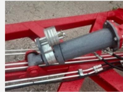
Regulación de inclinación de chasis con respecto a la lanza mediante un cilindro hidráulico con un sistema de topes a resortes, para asegurar la posición del cilindro y la inclinación deseada en todo momento del trabajo.
