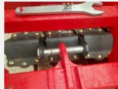
Regulación de paquete delantero para distintos trabajos y cruce de paquete delantero con respecto al trasero, con sistema de topes que asegura la posición en el trabajo y además evita que los discos delanteros se muevan en posición de transporte.
