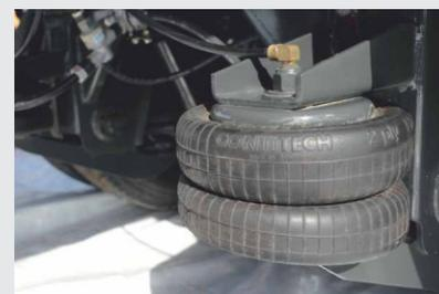
Pulmón de elevación del eje direccional.
