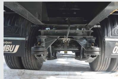
Eje direccional con izaje neumático.
